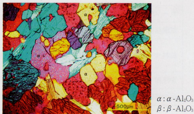
図4 電鋳アルミナれんがの微構造(偏光顕微鏡写真)
