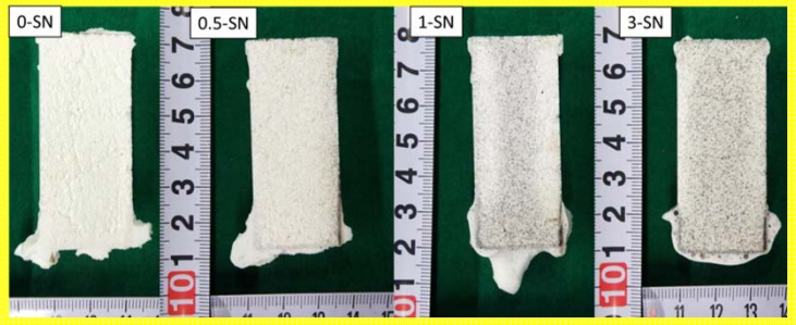
図5 1500°C、10minでの浸漬テスト後の切断面写真
