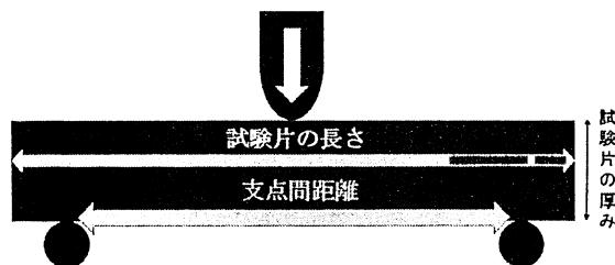
図1 三点曲げ強さ試験の概略図
