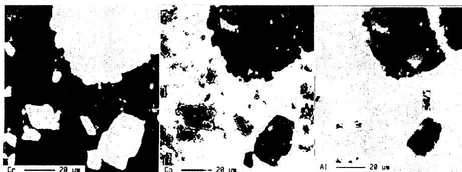
図11 水冷スラグ断面の面分析像（試験に用いた耐火物中 $\text{Cr}_2\text{O}_3$ 含有量：62%）
