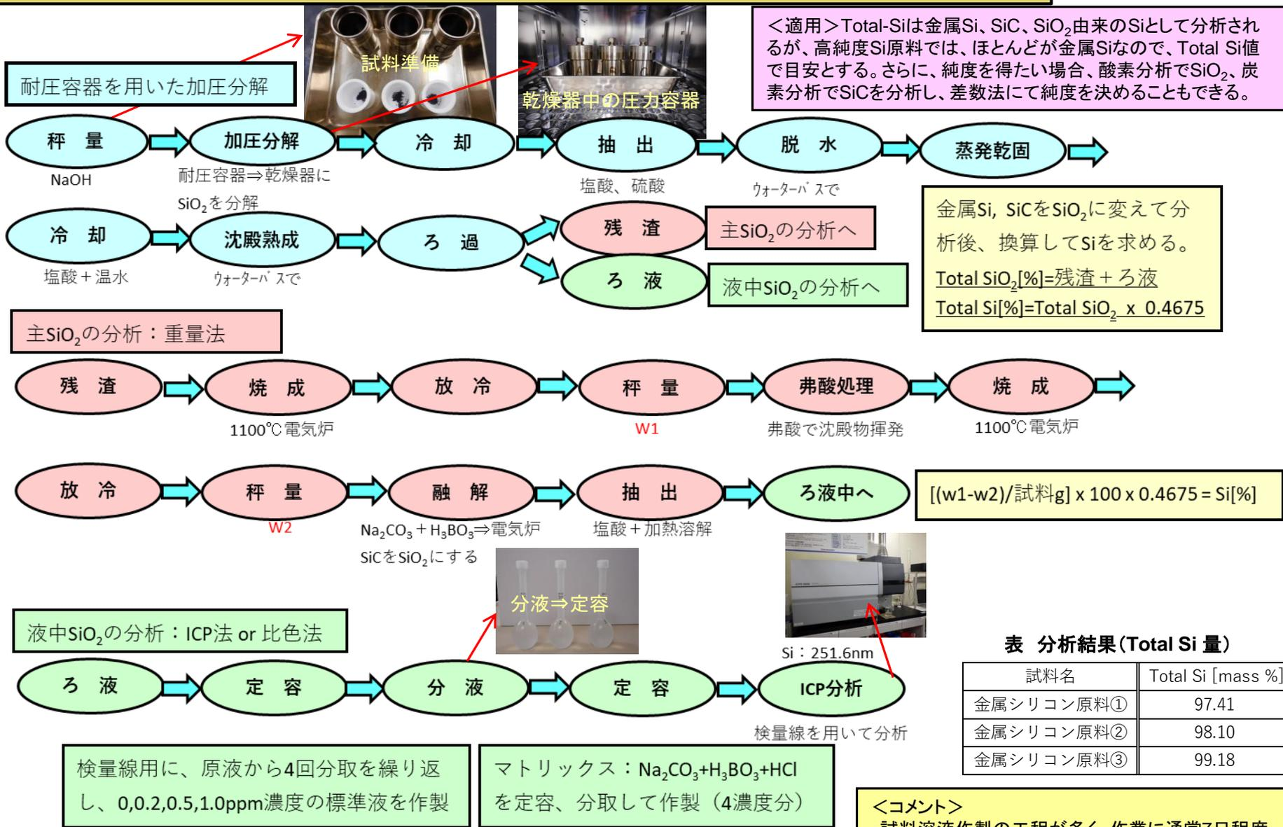
図 Total-Siの分析フロー (重量法+ICP法)
