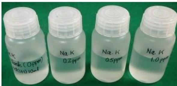
試料溶液(R034, R035, R036) 以外にブランク溶液も準備する
