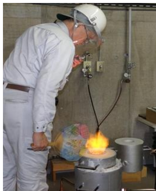
図1 耐火度測定の様子
