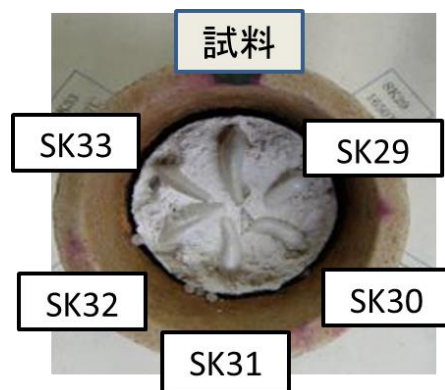
図3 耐火度測定後 (試料はSK32相当と判定)
