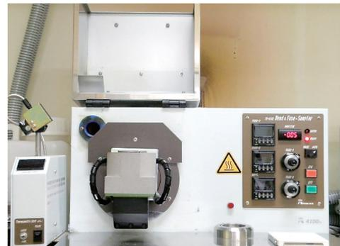
図3 高周波誘導炉の外観写真
