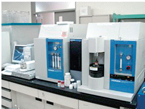
図1 酸素・窒素分析装置（左よりパソコン、マイクロ天秤、検出器部、酸化器、インパルス炉）
