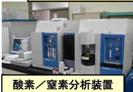
試料中に含まれている酸素・窒素を不活性ガス(He)ーインパルス加熱融解法によって抽出し、酸素を一酸化炭素として非分散型赤外線検出器(NDIR)で、また、窒素を熱伝導度検出器(TCD)で測定する。
