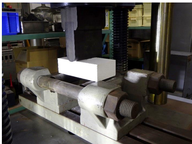
耐火物用3点曲げ試験治具：JIS R 2213 (治具総重量：約180kg)
