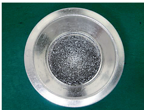
図3 損傷小白金皿の上面写真
