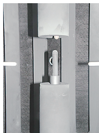
荷重下膨張・クリープ測定状態
