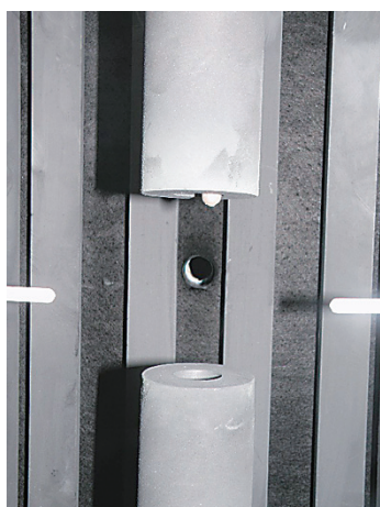
荷重軟化点測定状態
