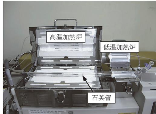
図2 加熱炉部写真
