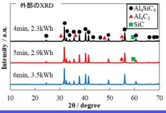
内部は $Al_4SiC_4$ 単相であったが、外部に $Al_4C_3$ が生成した
