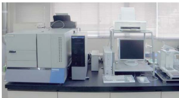
図2 カーボン分析装置 （本体、酸化器、パソコン、天秤）
