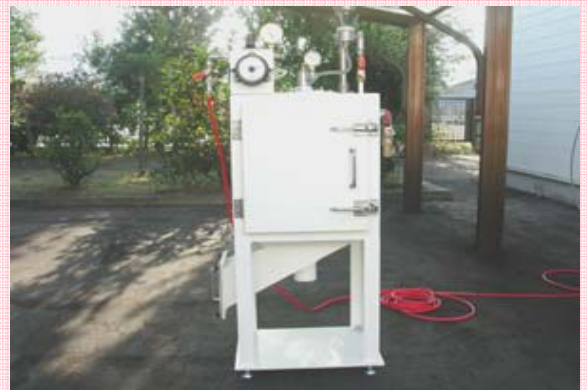
組み立てたASTM方式による耐摩耗テスト試験器
