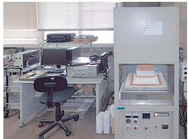
図3 熱伝導率測定装置概観写真
